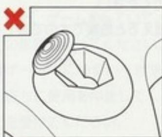
この時に、3Dスティックが傾いている場合(左上の図)、傾いた状態が「ニュートラルポジション」と設定されます。このようにニュートラルポジションの位置がズレた状態では、3Dスティックが正常に操作できなくなります。
